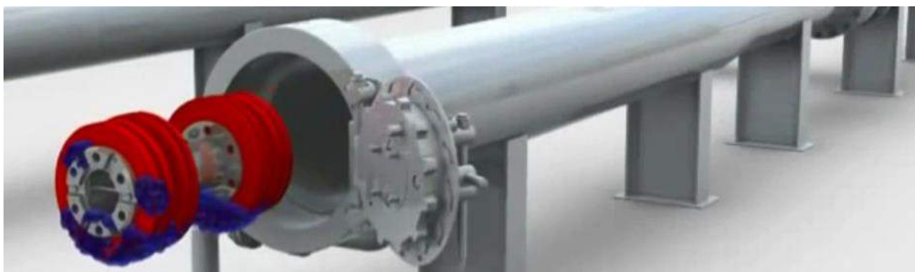
Hình 3.1. Thiết bị PIG làm sạch đường ống dẫn dầu
